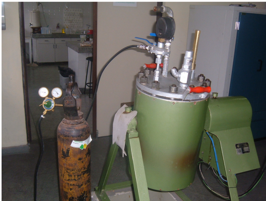
FIGURA 2.1 – REATOR SENDO PRESSURIZADO COM OXIGÊNIO NO INÍCIO DA ETAPA
