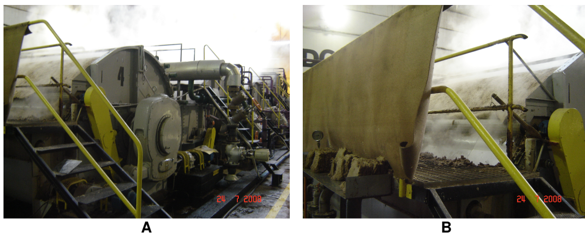
FIGURA 1.1 - (A) SÉRIE DE LAVADORES A VÁCUO PARA RETIRADA DO LICOR DE COZIMENTO (B) POLPA AO FINAL DO PROCESSO DE LAVAGEM, APÓS O COZIMENTO
