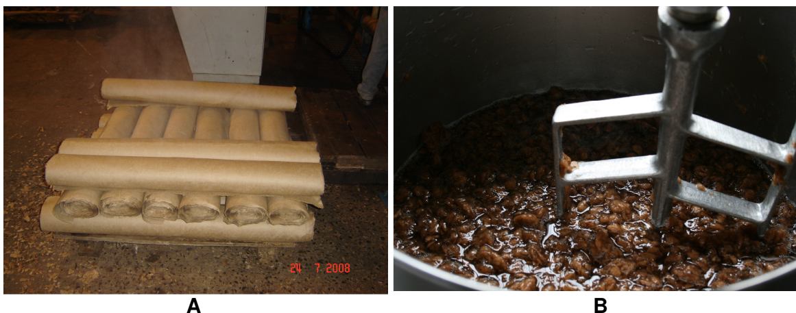
FIGURA 1.2 - (A) POLPA KRAFT DESAGUADA E ACONDICIONADA EM MANTAS (B) POLPA DESAGREGADA SENDO PREPARADA PARA AS ANÁLISES
