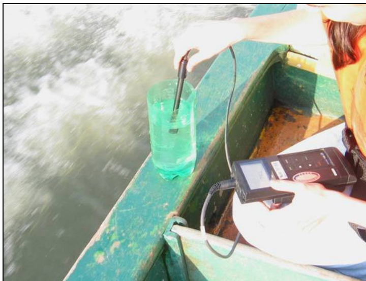
Figura 9. Metodologia utilizada para medir a condutividade superficial da água no trecho final do Canal de São Francisco.
