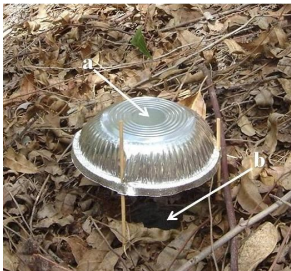
Figura 1: Modelo de armadilha de queda ( pitfall ) para coleta de fauna edáfica instalada em povoamentos de Acacia mangium (acácia), Mimosa artemisiana (mimosa), Eucalyptus grandis x E. urophylla (eucalipto) e Floresta Secundária, em Além Paraíba (MG). a) proteção contra chuva; b) recipiente enterrado ao nível do solo contendo conservante (formol 5%).
