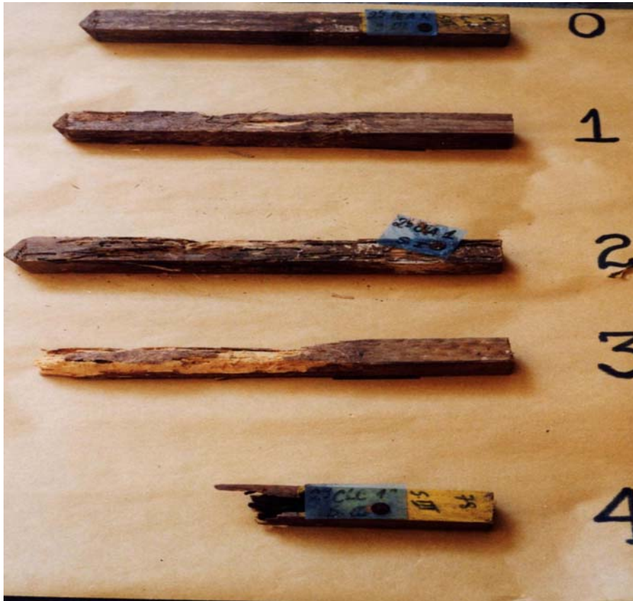
Figura. 14. Classificação representativa dos níveis de desgaste pelos cupins nos corpos-de-prova.
