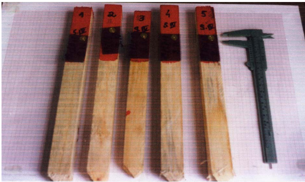
Figura 9. Corpos-de-prova com as etiquetas de identificação adicional fixadas por “percevejos” metálicos.
