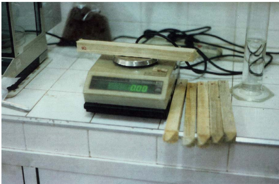
Figura 3. Balança eletrônica modelo BG GEHKA 1000 utilizada na aferição da perda de massa.
