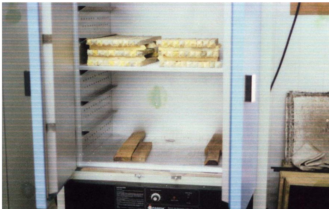
Figura 4. Secagem dos corpos-de-prova sob temperatura de 103\pm 3^{\circ}\text{C} em estufa modelo SE-320 FANEN
