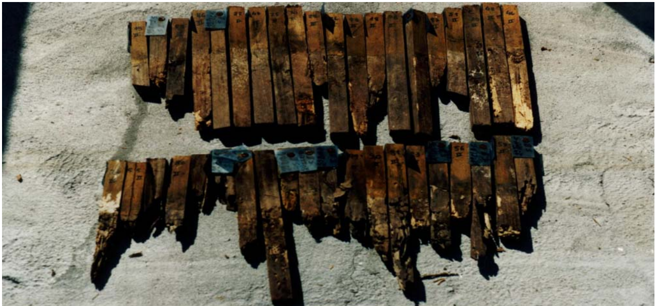
Figura 23. Estado final dos corpos-de-prova após 18 meses de exposição aos cupins.
