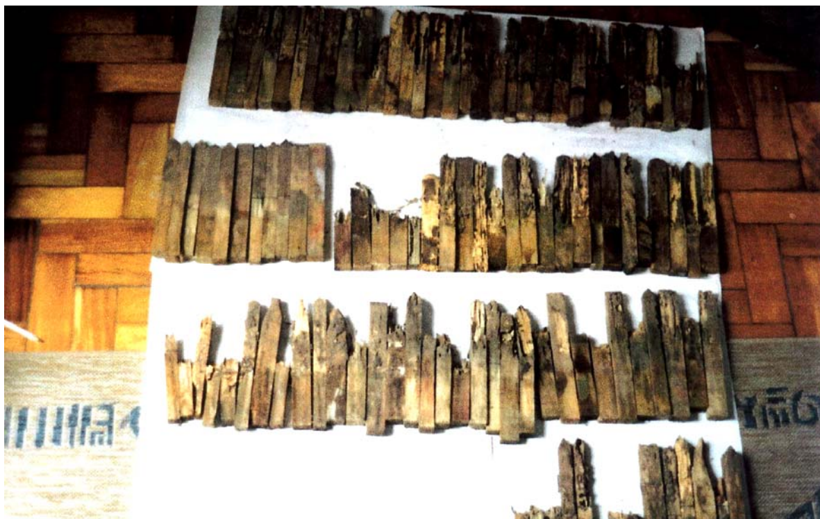
Figura 6. “Estacas-iscas” utilizadas no processo de pré iscagem após doze meses de permanência no solo.
