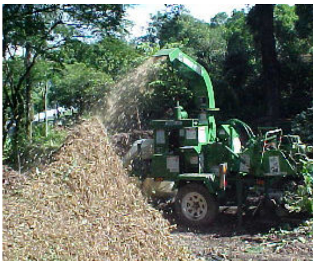
Figura 2 – Equipamento triturando galhadas
