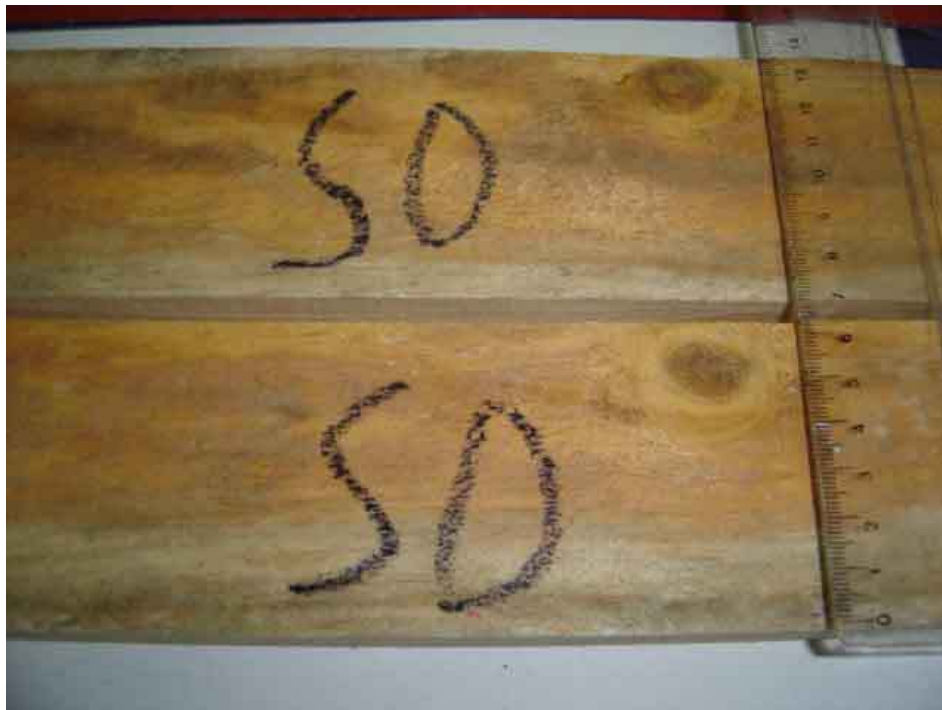
Figura 1: Material selecionado e descartado pela presença de medula e nós, executada no DPF/IF/UFRRJ.
