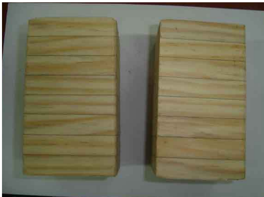
Figura 6: Corpos-de-prova de pinus para teste de delaminação segundo a norma da ASTM D-1101.
