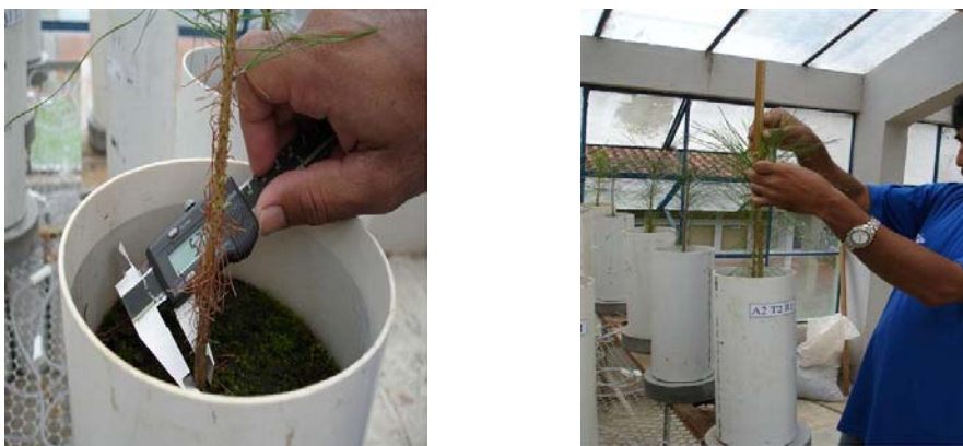
FIGURA 8 – COLETA DE DIÂMETRO DO COLO E ALTURA DAS MUDAS
