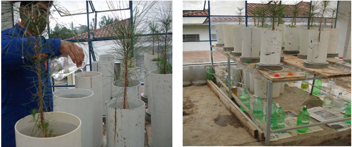
FIGURA 10 – COLETA DA ÁGUA DE PERCOLAÇÃO
