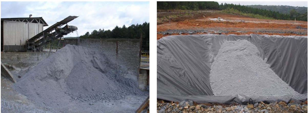
FIGURA 5 – RESÍDUO CENTRIFUGADO E ATERRO INDUSTRIAL NA CVG
