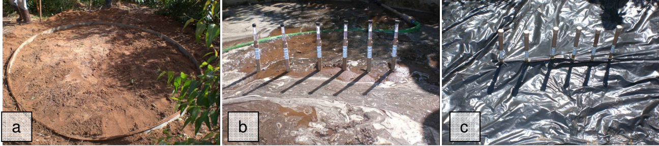
Figura 5 – Etapas de campo para obtenção da função K(\theta) : a) Lâmina metálica após a implantação; b) Saturação do solo; e c) Lona colocada sobre o solo, após a saturação
