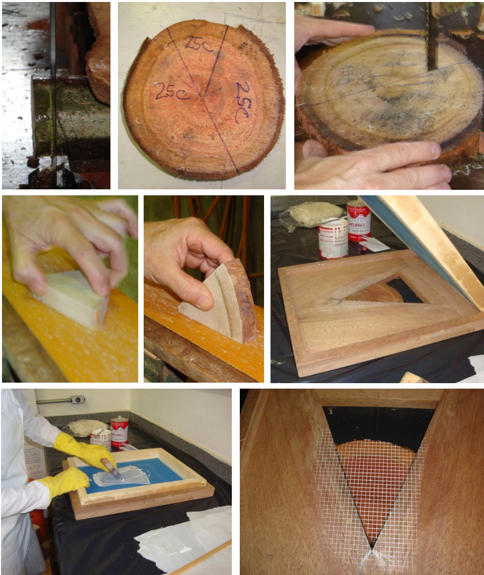
Figura 15 – Sequência de obtenção e preparo das amostras, da esquerda para a direita e de cima para baixo: Obtenção do disco após regularização da base do torete; marcação das cunhas; corte das amostras na serra-fita; polimento da superfície de estudo; regularização das laterais; posicionamento da amostra na base; impressão da grade e amostra em forma de cunha estampada
