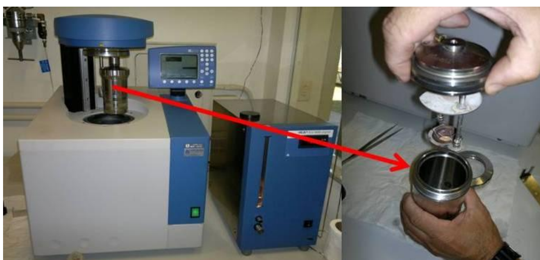
Figura 9 - Equipamento utilizado para determinação de poder calorífico ("C 2000 calorimeter system" - Ika® Werke). Detalhe da bomba calorimétrica (seta vermelha).
