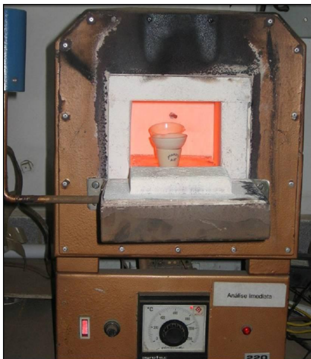
Figura 10 - Equipamento utilizado para análise imediata de uma amostra de resíduo utilizando-se cadinho de platina com tampa e mufla (capacidade de atingir 1.000°C). Fonte: Lopes, 2012.
