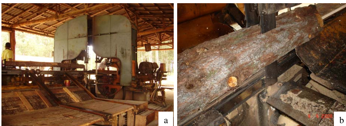
Figura 5 – Processamento das toras do plantio de 1992 em serra dupla: (a) posicionamento da tora e em (b) prancha principal
