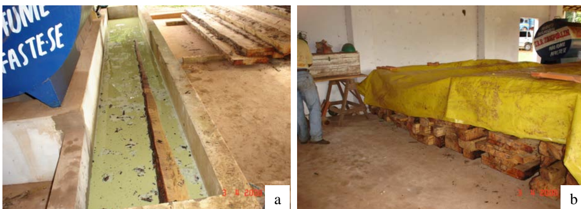
Figura 6 – Tratamento preservativo com banho de imersão (a) e em campo escuro (b)
