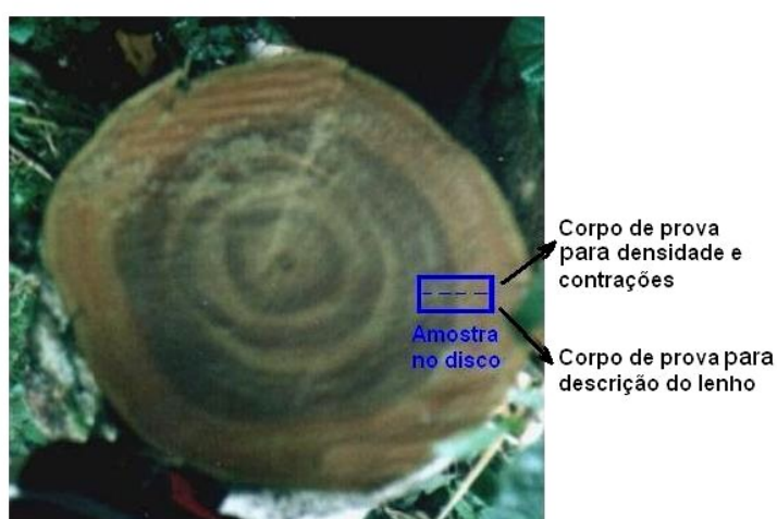
Figura 12 - Seção transversal do disco do lenho de gmelina e localização dos corpos de prova
