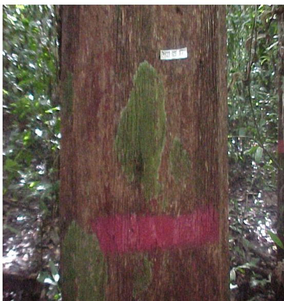
Figura 6 - Ponto de medição do diâmetro marcado com tinta óleo vermelha. Flona Tapajós, Belterra-PA
