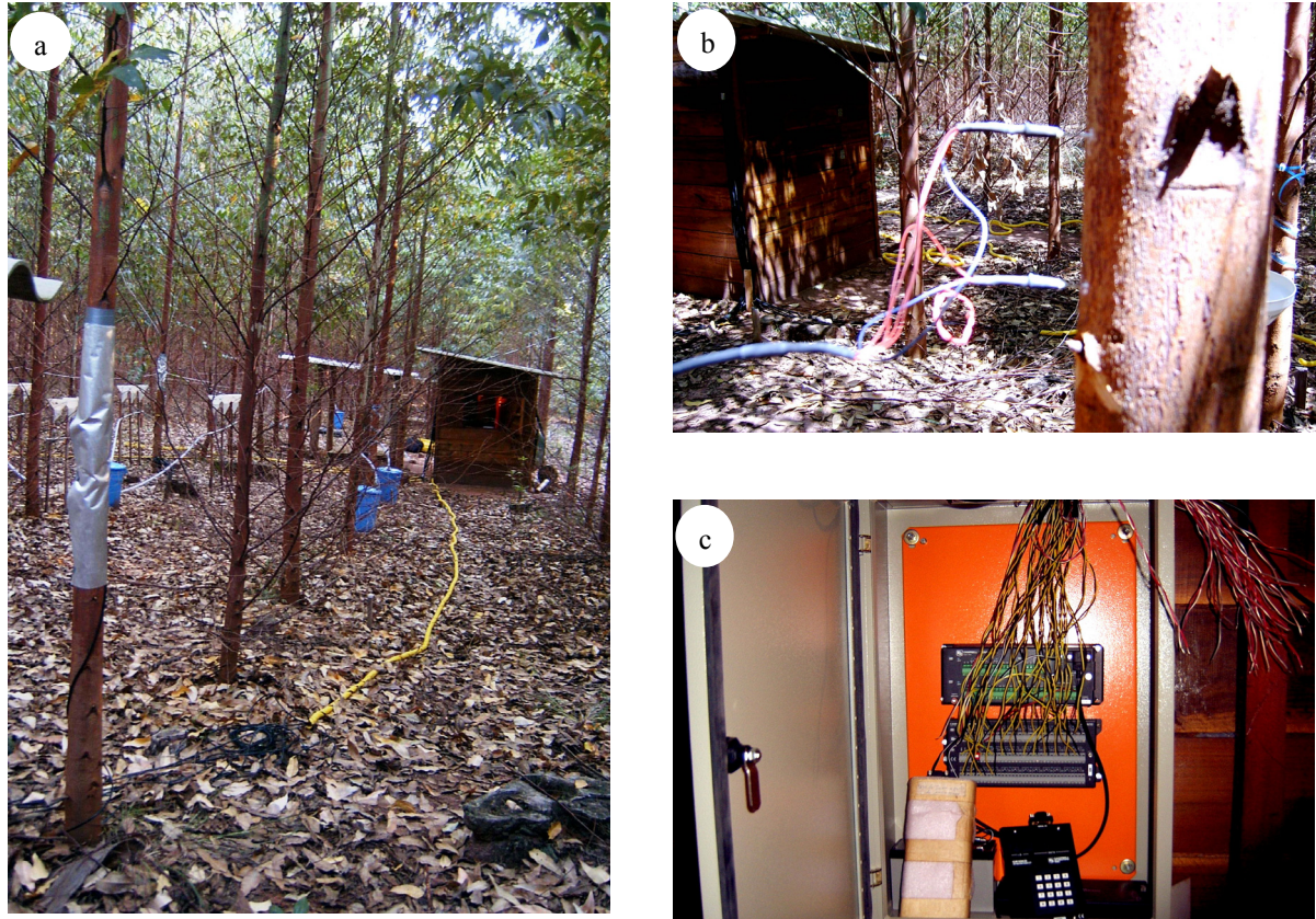
Figura 5 - Dispositivos para medição do fluxo de seiva no campo: (a) Vista geral da área; (b) Sensores de Granier; (c) Instalações elétricas do conjunto Datalogger e fontes de calor
