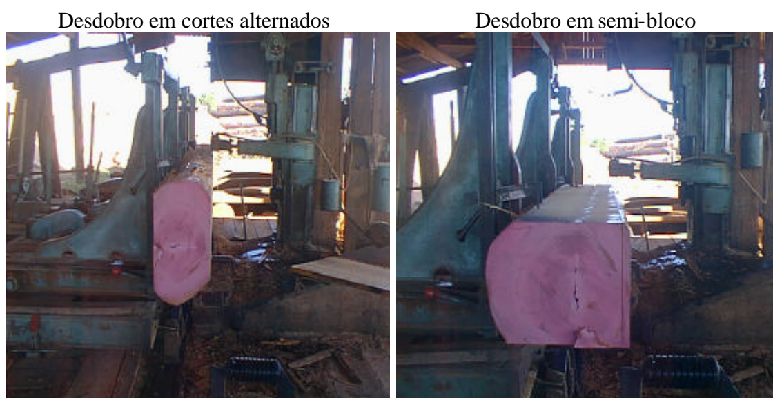
FIGURA 9. PROCESSO DE DESDOBRO DAS TORAS NA SERRA FITA
