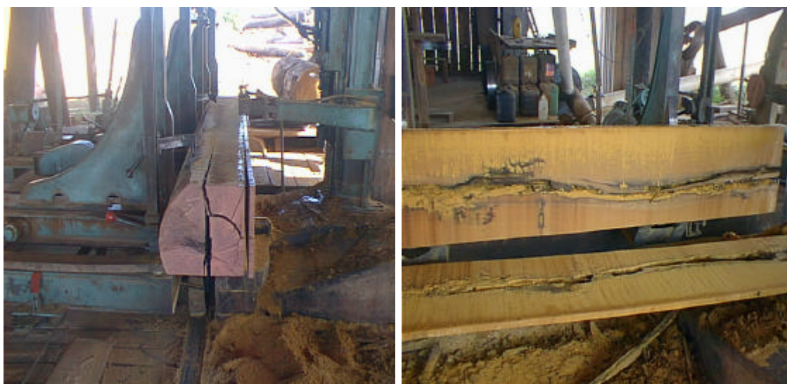
FIGURA 12. DEFEITO EM MADEIRA DE ITAÚBA ( M. itauba ) DURANTE O DESDOBRO EM SERRA FITA
