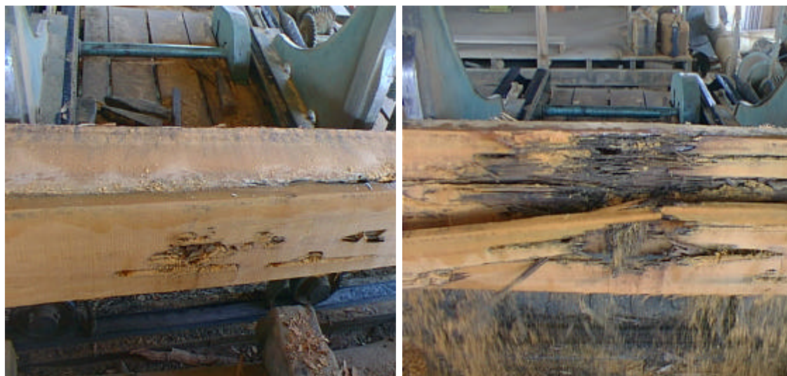
FIGURA 11. TORA DE CEDRINHO ( E. uncinatum ) DESDOBRADA EM SERRA FITA, PODRIDÃO INTERNA
