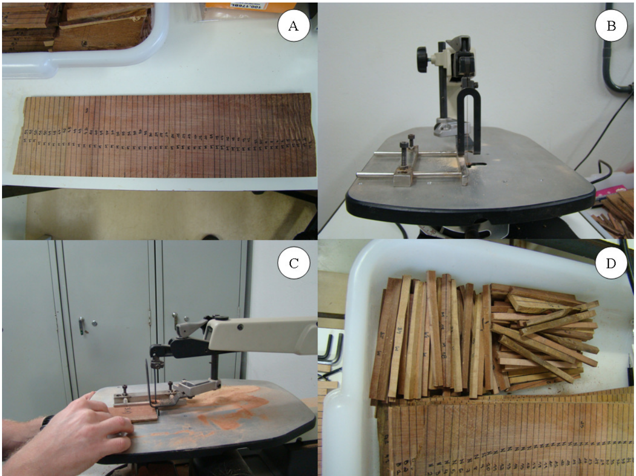
Figura 29 – Subamostras para análise de densidade aparente, marcação das subamostras (A), serra tico-tico utilizada (B), obtenção das subamostras (C), detalhe do material (D)
