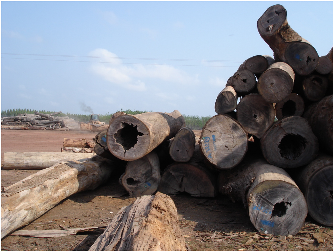
Figura 4 – Toras com presença de oco no pátio da serraria Cikel Brasil Verde Madeira Ltda. (Paragominas – PA)
