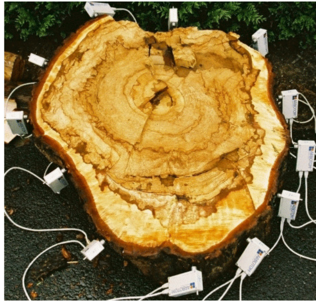
Figura 7 – Sensores do tomógrafo instalados no disco de madeira (Fonte: RINNTECH, 2007)
