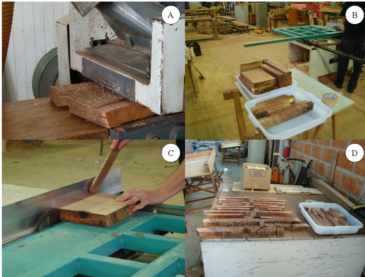
Figura 26 – Seqüência de preparo das amostras para estudo de densidade aparente, processamento das amostras (A), detalhe das amostras e subamostras (seta) (B), obtenção de subamostras para densitometria de raios X anatomia (C), subamostras (D)
