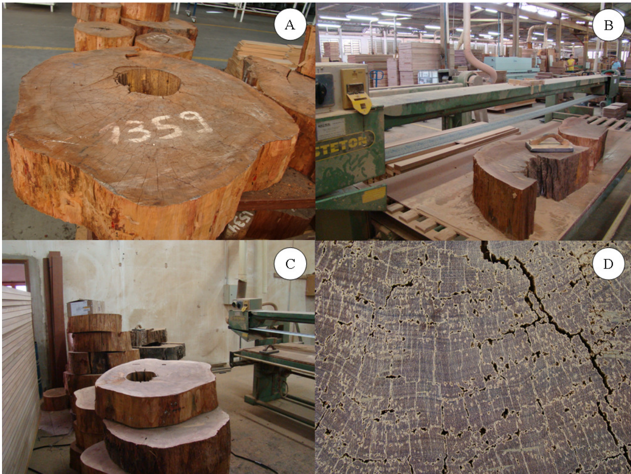
Figura 19 – Seqüência de lixamento de uma face do disco, superfície sem lixar (A), lixadeira de cinta estacionária (B), superfície lixada (C), detalhe do acabamento da superfície lixada (D)
