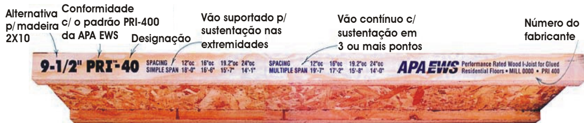
FIGURA 3 – PADRONIZAÇÃO DE VIGA “I”
