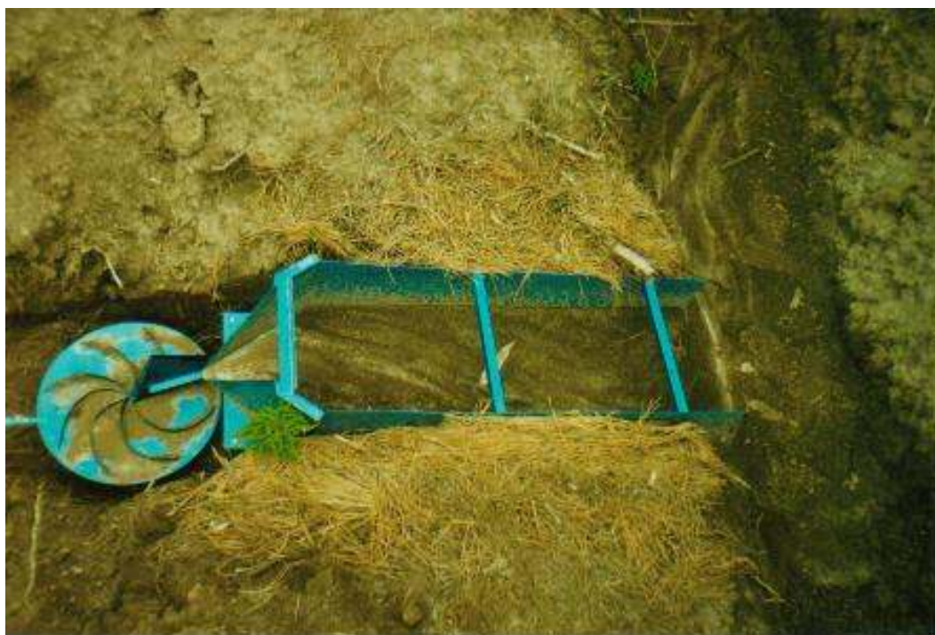
FIGURA 1 – CALHA COLETORA DE ENXURRADA E SEDIMENTOS – ( RODA COSHOCTON )
