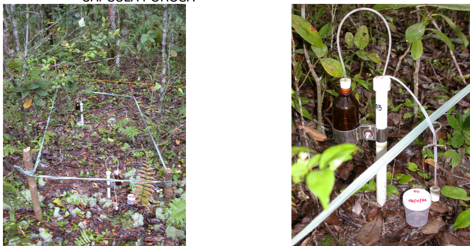
FIGURA 4.6 - DISTÂNCIA ENTRE COLETORES DE SOLUÇÃO DE SOLO E DETALHE DA CÁPSULA POROSA
