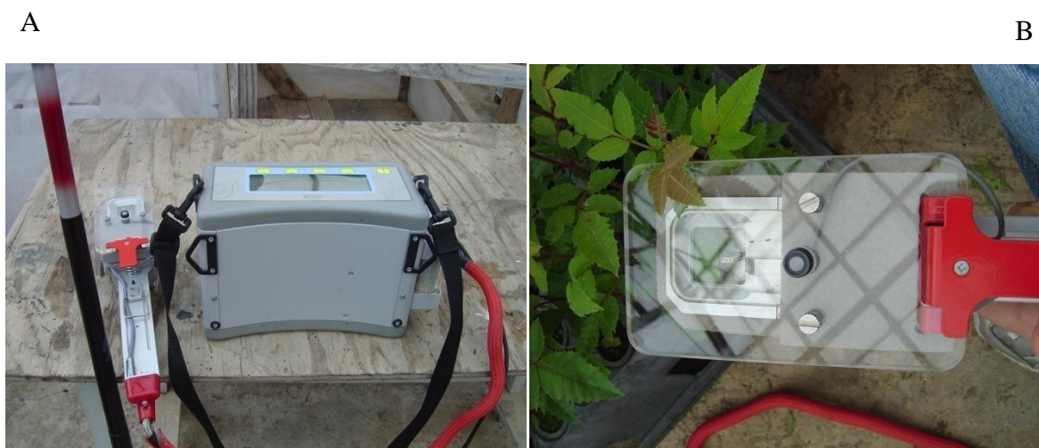
ANEXO 13: ANALISADOR PORTÁTIL DE GASES POR INFRAVERMELHO MODELO LCPRO+ DA ADC BIOSCIENTIFIC LTD. UTILIZADO NAS AVALIAÇÕES DE TROCAS GASOSAS (A) E FOLÍOLO OCUPANDO METADE DA CÂMARA FOLIAR (B), VIVEIRO DA EMBRAPA FLORESTAS, COLOMBO – PR
