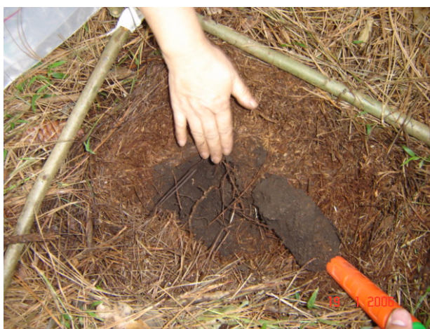
FIGURA 15 – Detalhe da amostragem do solo em povoamento florestal com P. taeda .
