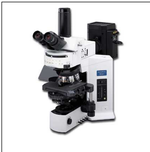
Figura 21: Microscópio ótico BX51M utilizado para a medição do tamanho das partículas sólidas (Fonte: Olympus Corporation , 2008)
