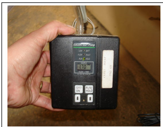
Figura 12: Bomba de amostragem marca MSA utilizada para coleta do aerodispersóide sólido do aglomerado (Fonte: A Autora, 2008)
