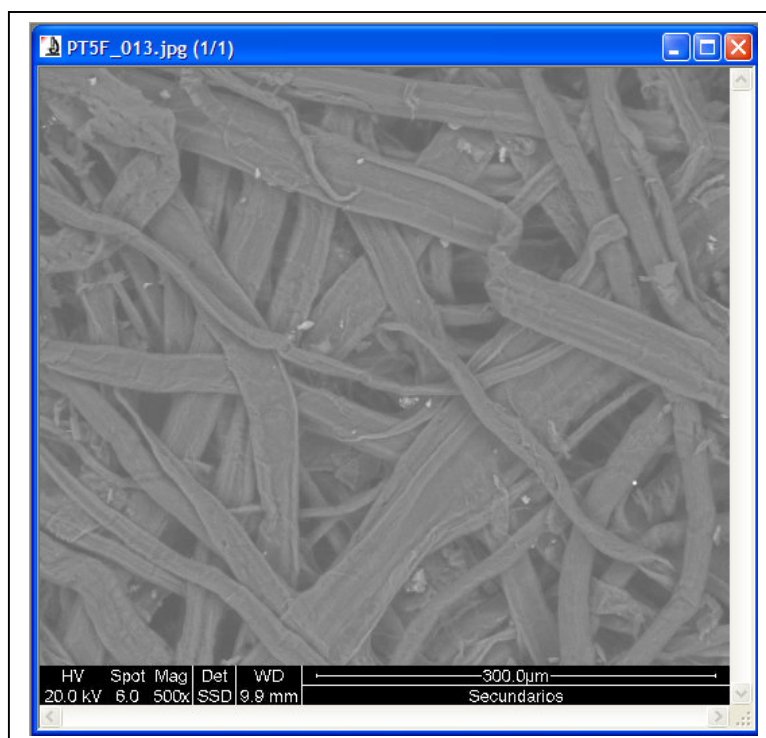
Figura 44: Imagem do campo microscópico central do filtro de poeira total PT5F analisado por microscopia eletrônica (Fonte: A Autora, 2008)
