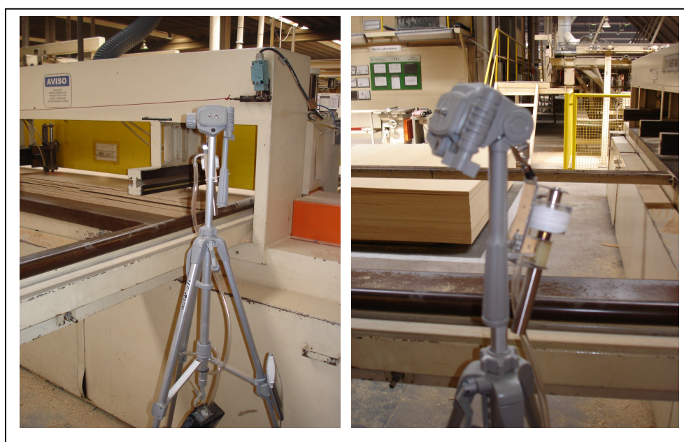
Figura 20: Configuração dos equipamentos para coleta de amostras de poeira respirável (PR) (Fonte: A Autora, 2008)
