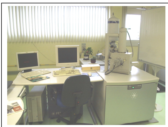
Figura 35: Microscópio eletrônico de varredura (MEV) utilizado para a medição (Fonte: A Autora, 2008)
