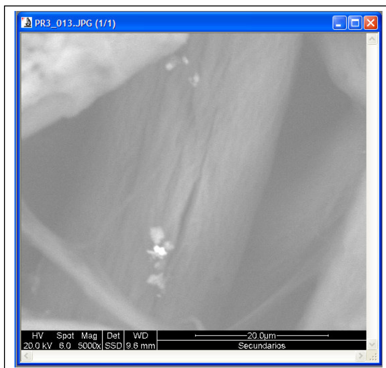
Figura 45: Imagem do campo microscópico central do filtro de poeira respirável PR3 analisado por microscopia eletrônica (Fonte: A Autora, 2008)
