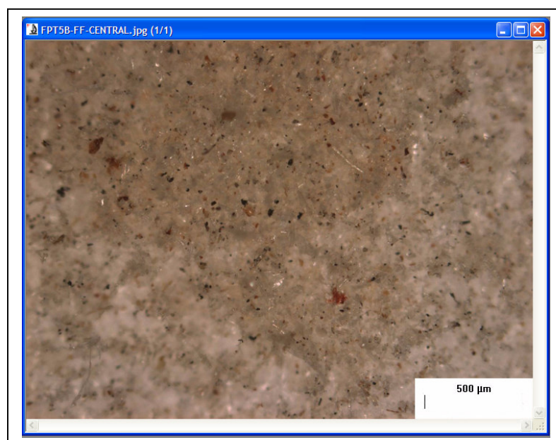
Figura 34: Imagem do campo microscópico central (2C) do filtro de poeira total PT5B com particulado de painéis aglomerado com revestimento FF analisado por microscopia ótica (Fonte: A Autora, 2008)
