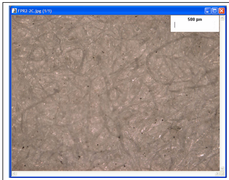
Figura 31: Imagem do campo microscópico central (2C) do filtro de poeira respirável PR2 analisado por microscopia ótica (Fonte: A Autora, 2008)
