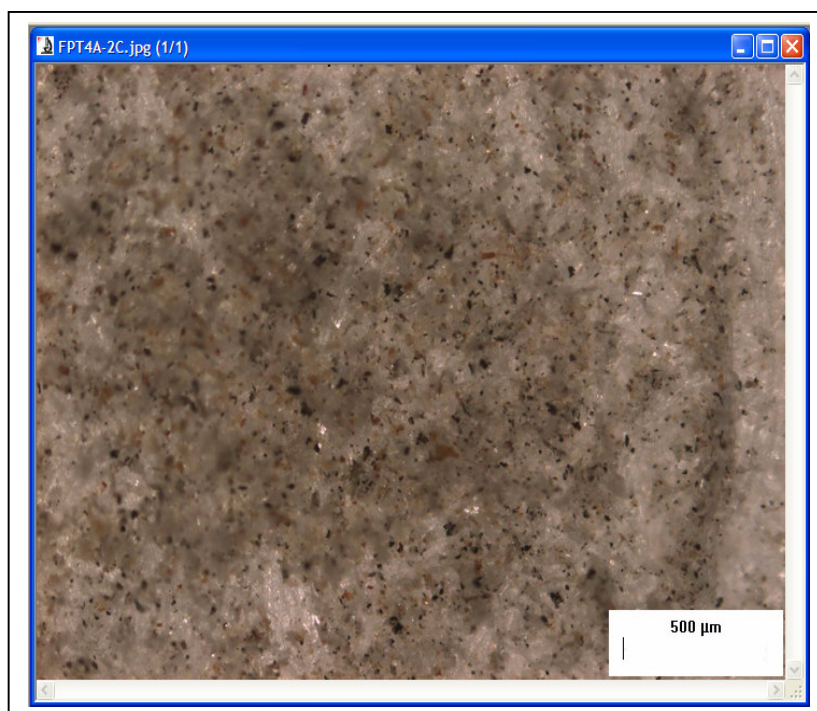
Figura 27: Imagem do campo microscópico central (2C) do filtro de poeira total PT4A analisado por microscopia ótica (Fonte: A Autora, 2008)
