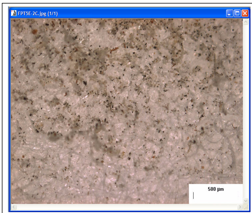
Figura 30: Imagem do campo microscópico central (2C) do filtro de poeira total PT5E analisado por microscopia ótica (Fonte: A Autora, 2008)
