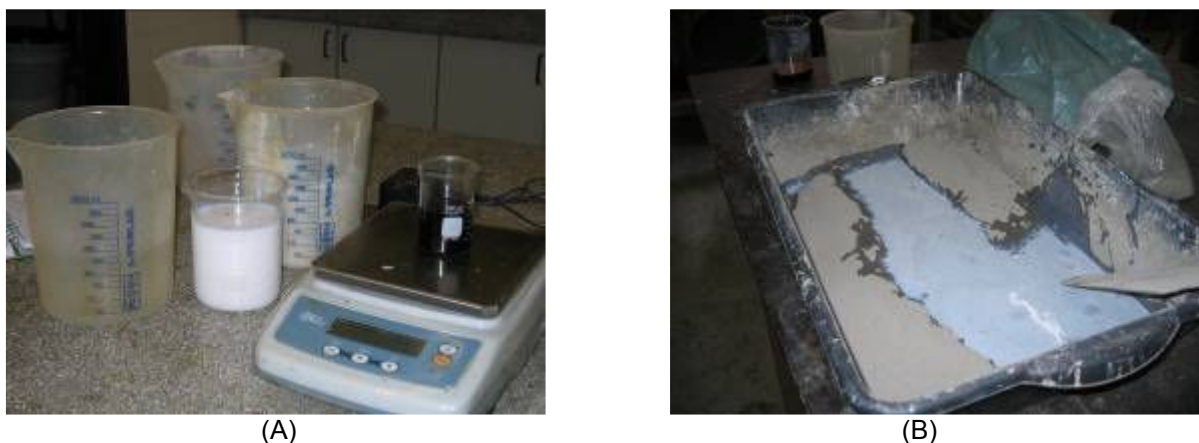
(A) (B) FIGURA 17 - PROCEDIMENTOS DE DOSAGENS E PREPARO DA PASTA DE CIMENTO (A) PROCEDIMENTOS DE DOSAGENS DOS INSUMOS E ADITIVO (B) INÍCIO DO PREPARO DA PASTA COM A COLOCAÇÃO DA ÁGUA MAIS ADITIVO REFORÇADOR SOBRE O CIMENTO PORTLAND Fonte: O autor (2012)
