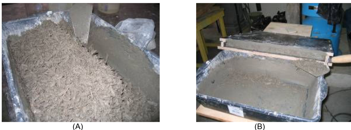
FIGURA 19 - PARTÍCULAS ENVOLVIDAS NA PASTA DE CIMENTO E MISTURA COMPACTADA (A) ASPECTO DAS PARTÍCULAS ENVOLVIDAS PELA PASTA DE CIMENTO E ADITIVOS (B) FINAL DO ENCHIMENTO E ACABAMENTO SUPERFICIAL DO CORPO DE PROVA
