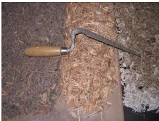
FIGURA 15 - PRÉ-TRATAMENTO DAS PARTÍCULAS DE TRONCO COM ÓXIDO DE CÁLCIO FONTE: O autor (2012)
