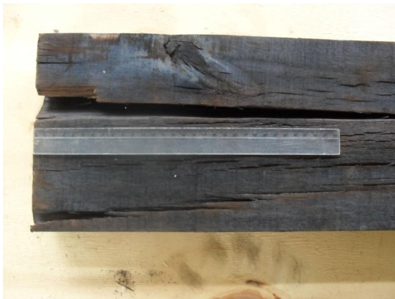
FIGURA 1.23 - RACHADURA LONGITUDINAL NA FACE TANGENCIAL DE UMA PEÇA DE MADEIRA DO TRATAMENTO 180°C CORRESPONDENTE À POSIÇÃO “D”
