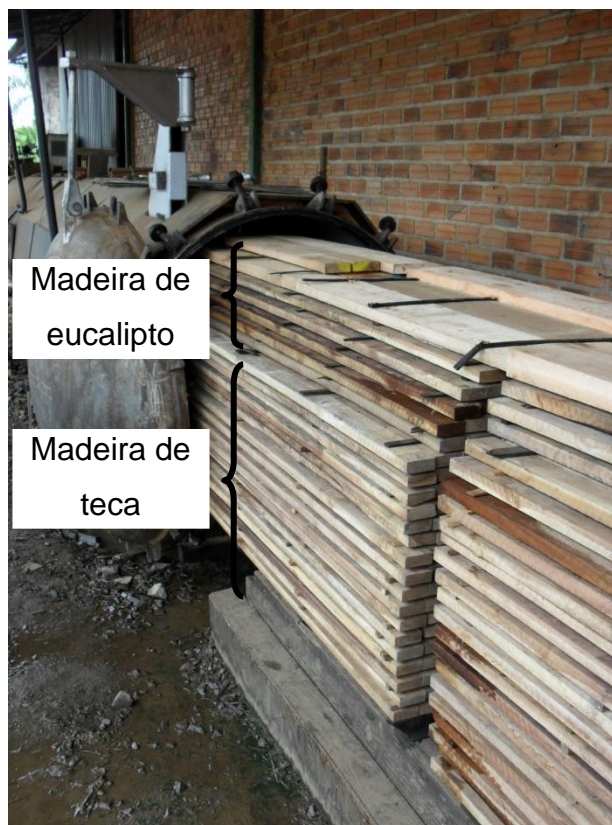
FIGURA 1.17 - CARREGAMENTO DO CILINDRO PARA A MODIFICAÇÃO TÉRMICA PELO PROCESSO VAP HolzSysteme®
