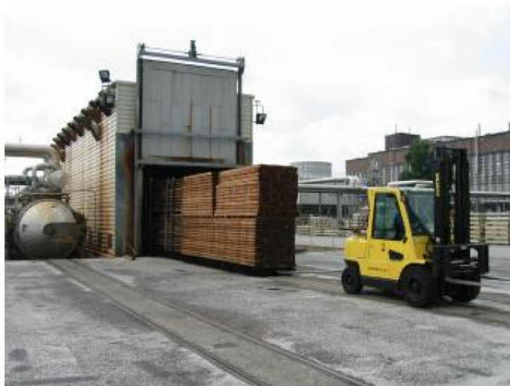
FIGURA 1.6 - CÂMARA DE SECAGEM UTILIZADA NA ETAPA DE “CURA” DA MADEIRA DO PROCESSO Plato®
