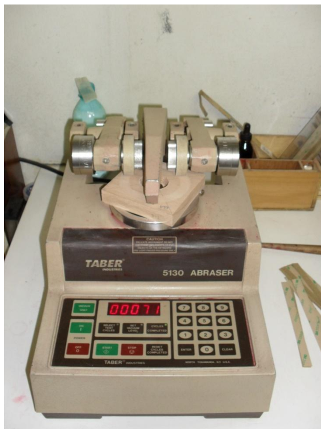
FIGURA 4.3 - EQUIPAMENTO TABER ABRASER UTILIZADO NO ENSAIO DE DESGASTE ABRASIVO
