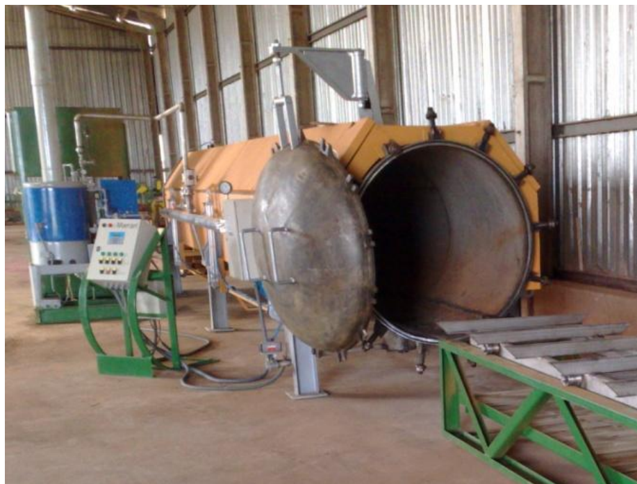
FIGURA 1.15 - VISTA GERAL DO EQUIPAMENTO UTILIZADO NO PROCESSO DE MODIFICAÇÃO TÉRMICA VAP HolzSysteme®
