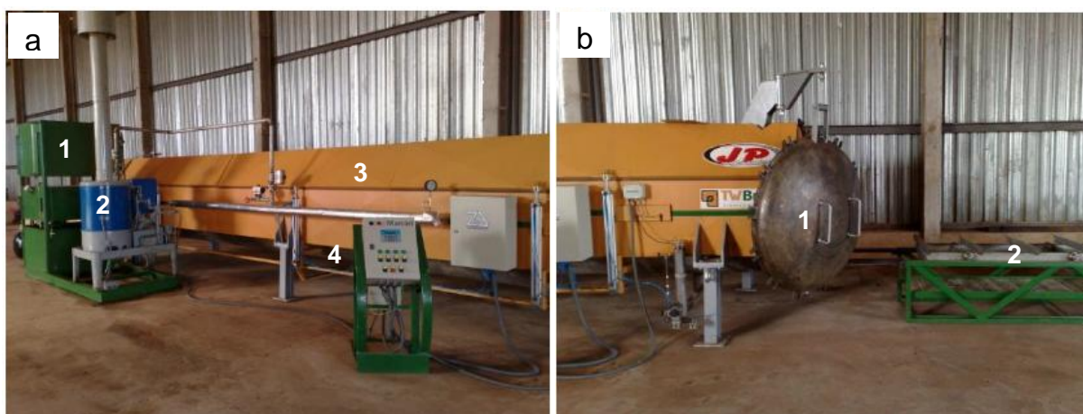
FIGURA 1.16 - DETALHES DOS COMPONENTES DO EQUIPAMENTO UTILIZADO NO PROCESSO VAP HolzSysteme®. a-1: RESERVATÓRIO DE ÁGUA; a-2: GERADOR DE VAPOR SATURADO; a-3: CILINDRO; a-4: CONTROLADOR LÓGICO PROGRAMÁVEL (CLP); b-1: PORTA DO CILINDRO; b-2: TRILHOS DO VAGONETE
