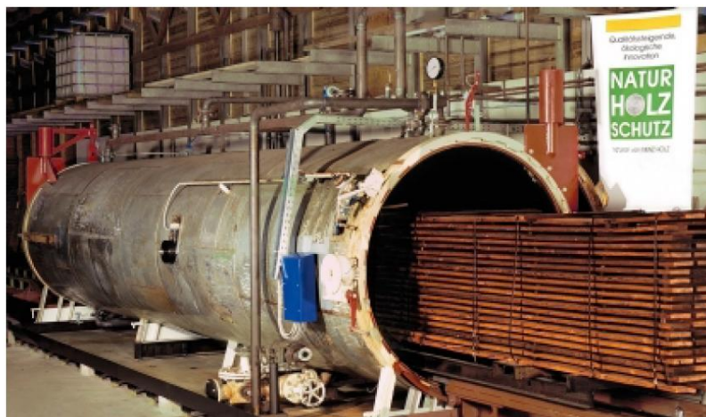
FIGURA 1.8 - CILINDRO UTILIZADO NA MODIFICAÇÃO TÉRMICA PELO PROCESSO Menz OHT ®
