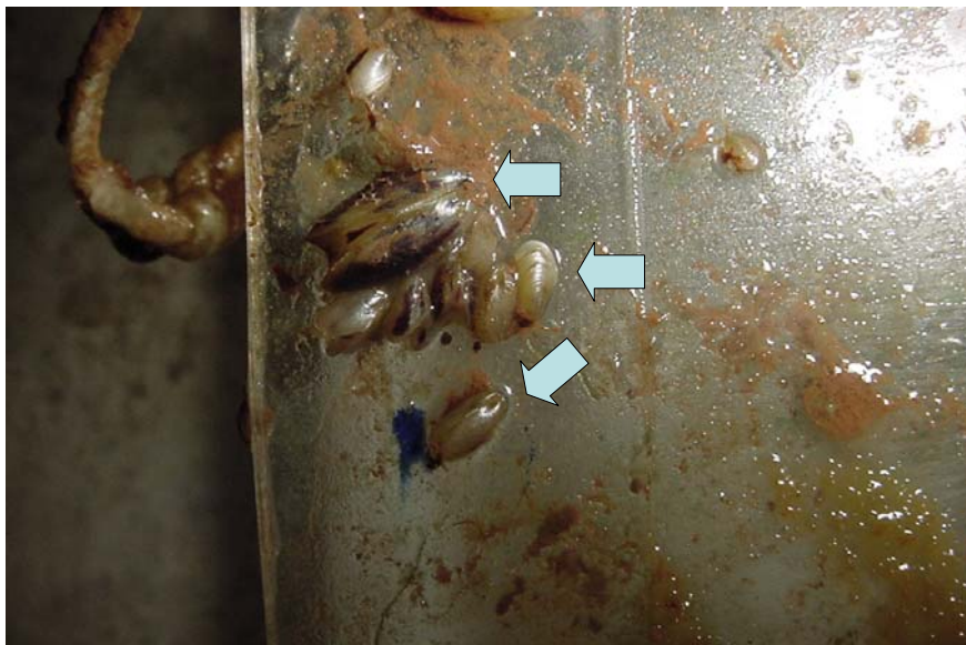
Figura 5-3. Placa retirada do reservatório após dois meses de permanência
