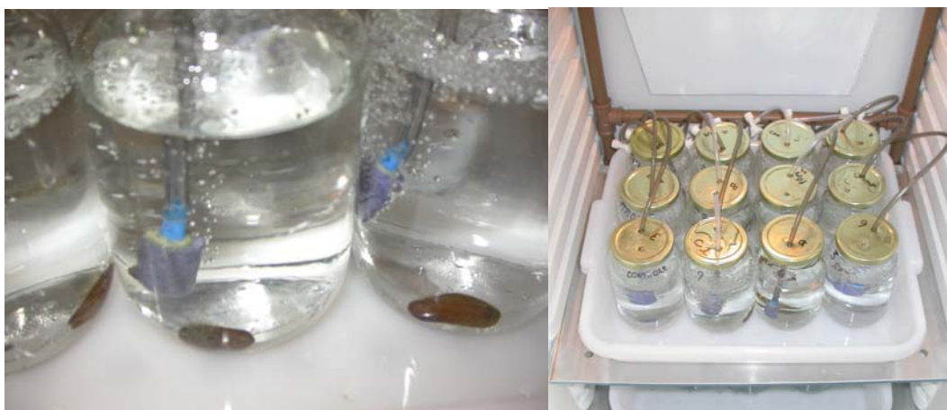
Figura 2-1. Baterias de testes de avaliação de taxa de filtração. Frascos com aeração dentro de incubadora.
