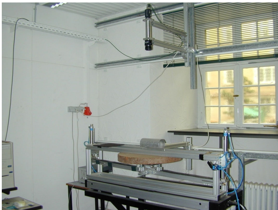
FIGURA 9 – APARELHO DE MEDIÇÃO DIGITAL DOS ANÉIS DE CRESCIMENTO, NO LABORATÓRIO DO INSTITUTO DE CRESCIMENTO FLORESTAL DA UNIVERSIDADE ALBERT LÜDWIGS, EM FREIBURG, ALEMANHA
