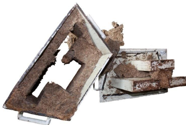
Figura 14: Exemplo de estrutura confeccionada com PVA que não foi possível desmoldar
