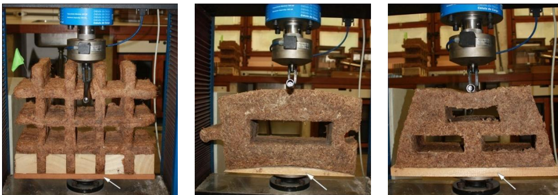
Figura 15: Ensaio de resistência a flexão no espaço vazio central dos diferentes tipos de estruturas. Destaque para os apoios de madeira
