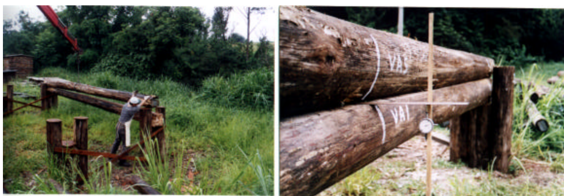
Figura 34 - Vigas bi-circulares sendo posicionadas sem conexão entre seus postes componentes (a) e preparada para o ensaio a flexão (b) com um relógio comparador posicionado no meio do vão livre.
