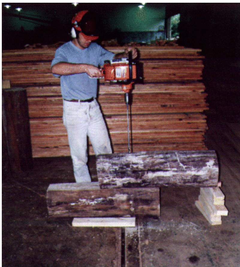
Figura 26 - Torettes componentes do corpo de prova sendo furados de forma contínua e perpendicularmente à face desbastada.
