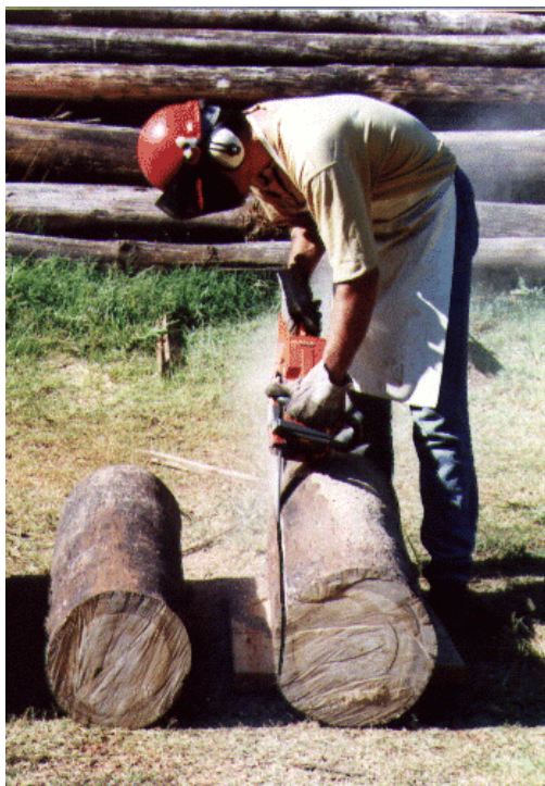
Figura 25 - Desbaste lateral dos toretes.
