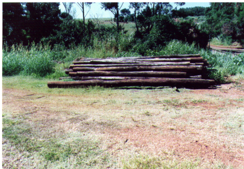
Figura 18 - Postes de Eucalipto citriodora acondicionados para secagem ao ar.
