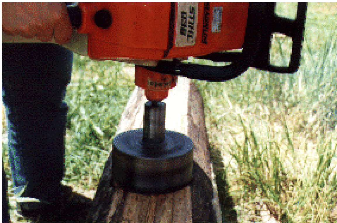
Figura 27 - Serra-copa sendo utilizada para fazer o sulco de alongamento do anel na madeira.
