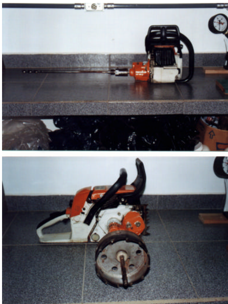
Figura 20 - Furadeira acoplada na própria motosserra portando a broca (a) ou a serra-copo com sua haste guia (b).
