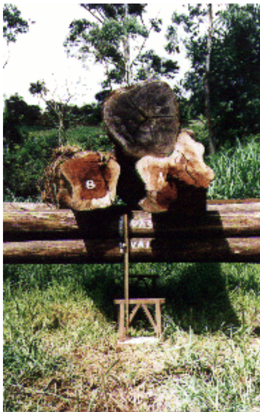
Figura 35 - Carregamento não destrutivo das vigas bi-circulares de seção composta de peças circulares independentes.
