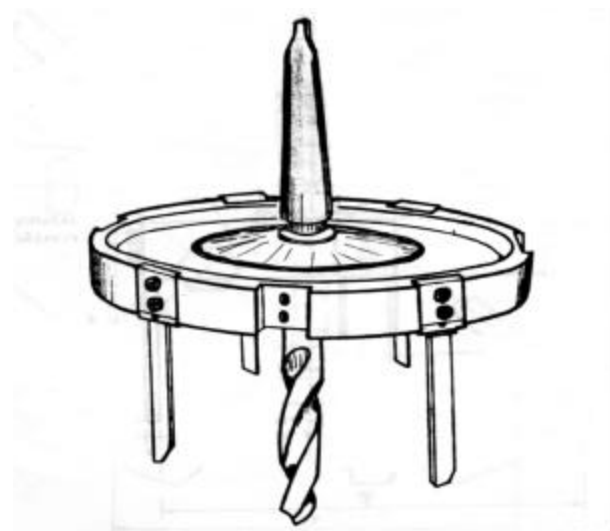
Figura 1 - Ferramenta para preparação do sulco de alojamento do anel.
