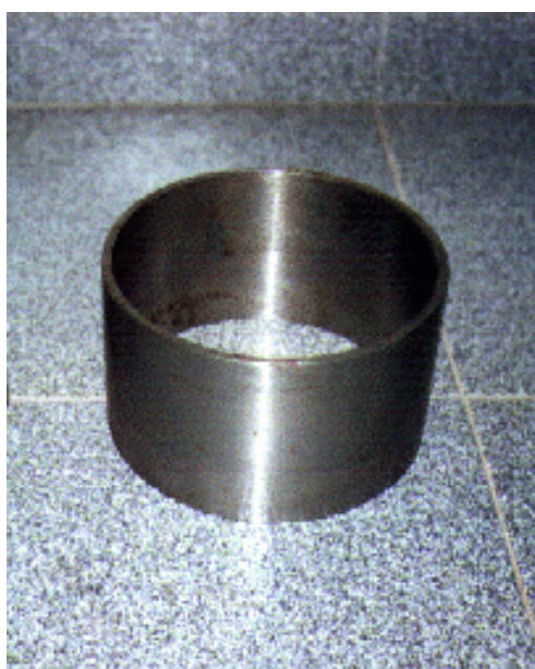
Figura 19 - Anel metálico de diâmetro de 150 mm.
