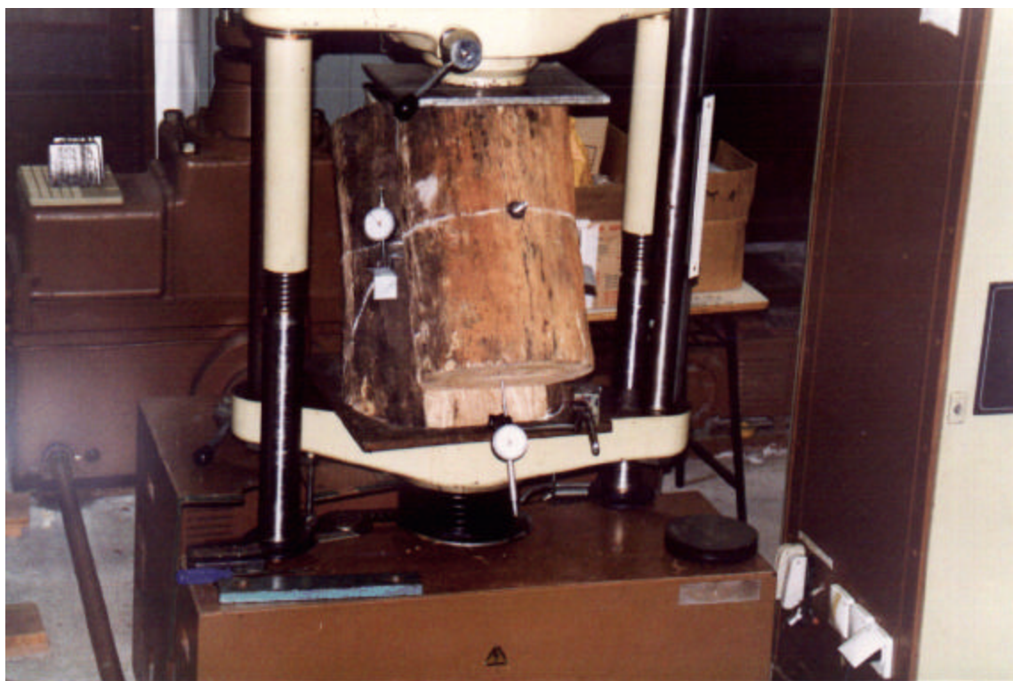
Figura 31 - Ensaio de compressão do corpo de prova para a obtenção dos deslocamentos relativo entre as duas peças roliças ligadas por um anel metálico.
