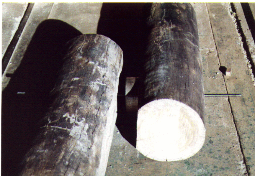
Figura 29 - Justaposição dos toretes pelo parafuso.
