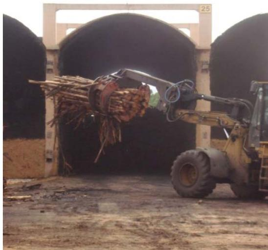
**Figura 5:** Carregamento do forno.
