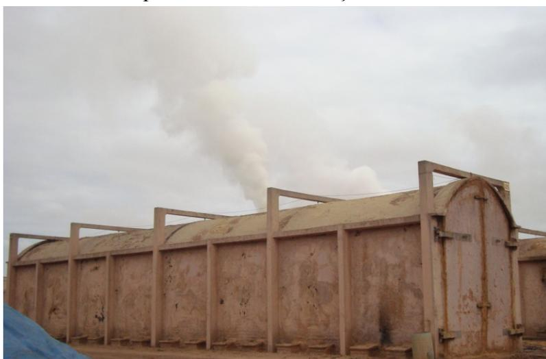
**Figura 6:** Forno em processo de carbonização.
