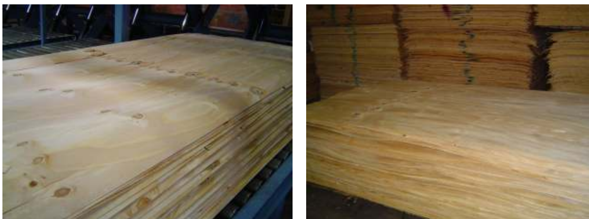
Figura 26 - Exemplos de lâminas com nós obtidas de primeira e segunda toras do talhão 50367 - Pinus taeda
