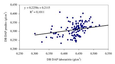
FIGURA 4 Relação entre análise de laboratório e amostras preditas no NIR para as características de densidade básica dos cavacos e densidade básica na altura do DAP das 120 amostras.
