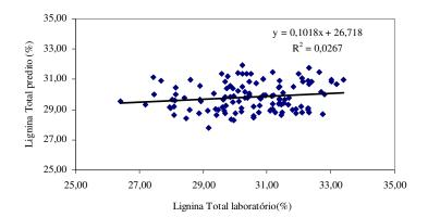
FIGURA 2 Relação entre análise de laboratório e amostras preditas no NIR para as características de extrativos em acetona e lignina total das 120 amostras.
