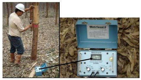
FIGURA 4 Temporizador de ondas de tensão em aplicação na direção transversal e longitudinal na árvore (detalhes do registrador do tempo em microssegundos)
