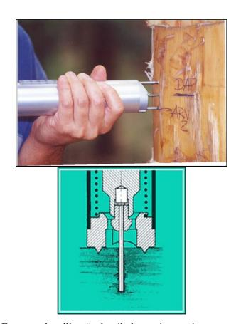
FIGURA 3 Esquema de utilização do pilodyn na árvore viva
