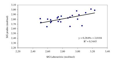
FIGURA 6 Relação entre análises de laboratório e amostras preditas na validação externa para as características de lignina total e relação S/G das 24 amostras.
