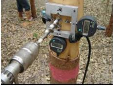
FIGURA 1 Extensômetro usado para a obtenção indireta da tensão longitudinal (DRL) e tangencial (DRT) de crescimento na árvore viva
