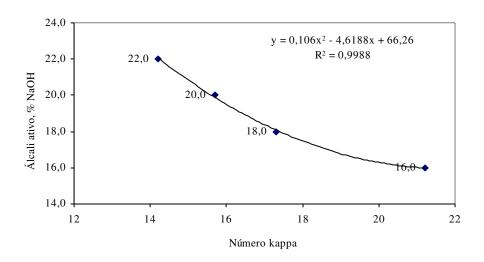
FIGURA 1 Estabelecimento da carga de álcali ativo requerida para kappa 17
