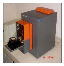
FIGURA 5 Espectrômetro NIRS, da marca FOSS, modelo NirSystem 5000
