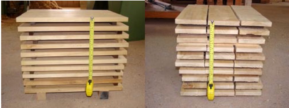
FIGURA 12. PRÉ-CORPOS-DE-PROVA PARA TESTE DE USINAGEM E ADERÊNCIA, ENTABICADOS NA EMPRESA ZAMELA MADEIRAS. FONTE: PESQUISA DE CAMPO.
