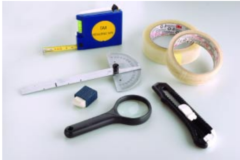
FIGURA 19. MATERIAIS UTILIZADOS NA REALIZAÇÃO DO TESTE DE ADERÊNCIA.
