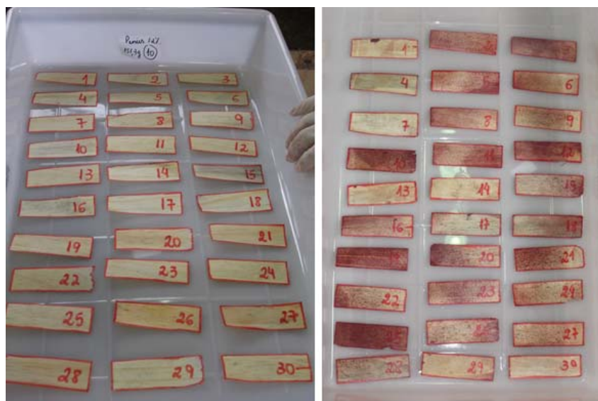
Figura 11 Partículas antes e após o encolamento
