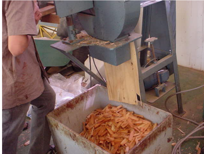
Figura 5 Geração das partículas “strand” em moinho de disco
