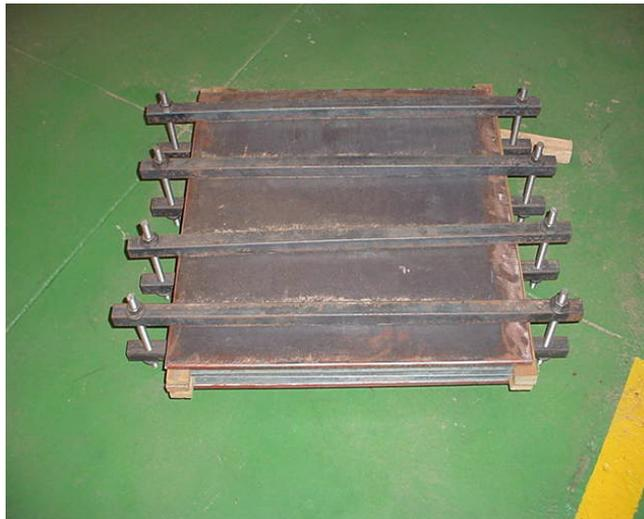
**FIGURA 7** – Sistema de grampeamento dos painéis.
