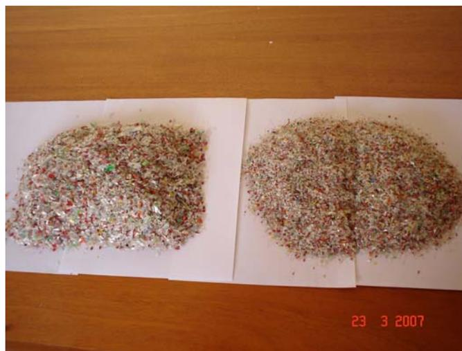
**FIGURA 8** – Granulometria das partículas de plástico do tipo PET.
