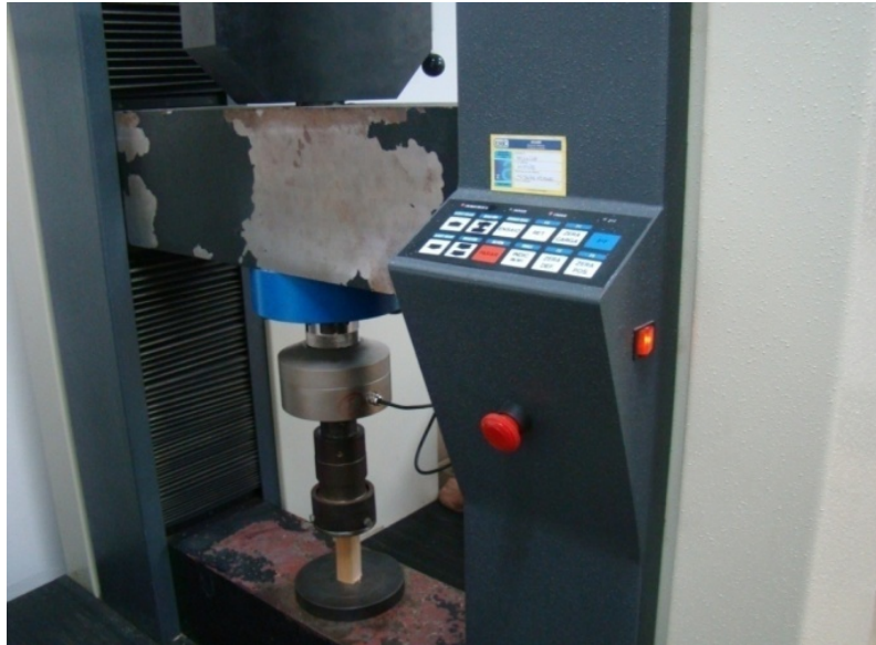
Figura 8 Ensaio de compressão paralela às fibras segundo a ASTM D 143 – 94, no Laboratório de Propriedades Físicas e Mecânicas da Madeira
