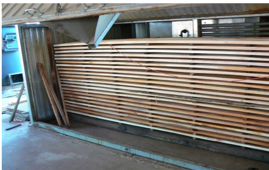
Figura 6 Secagem em estufa convencional
