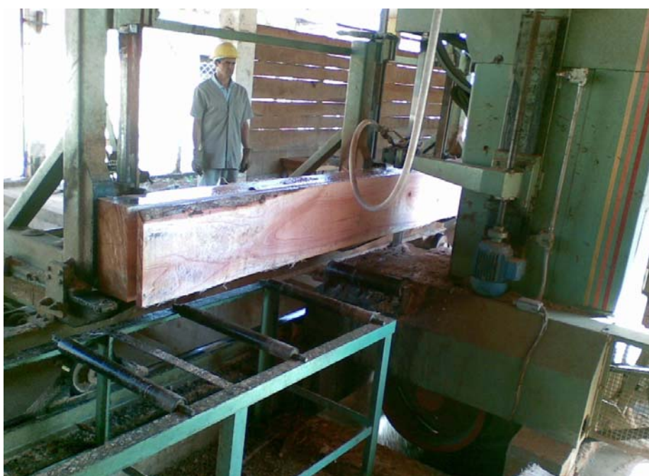
Figura 5 Desdobro das toras em serra de fita
