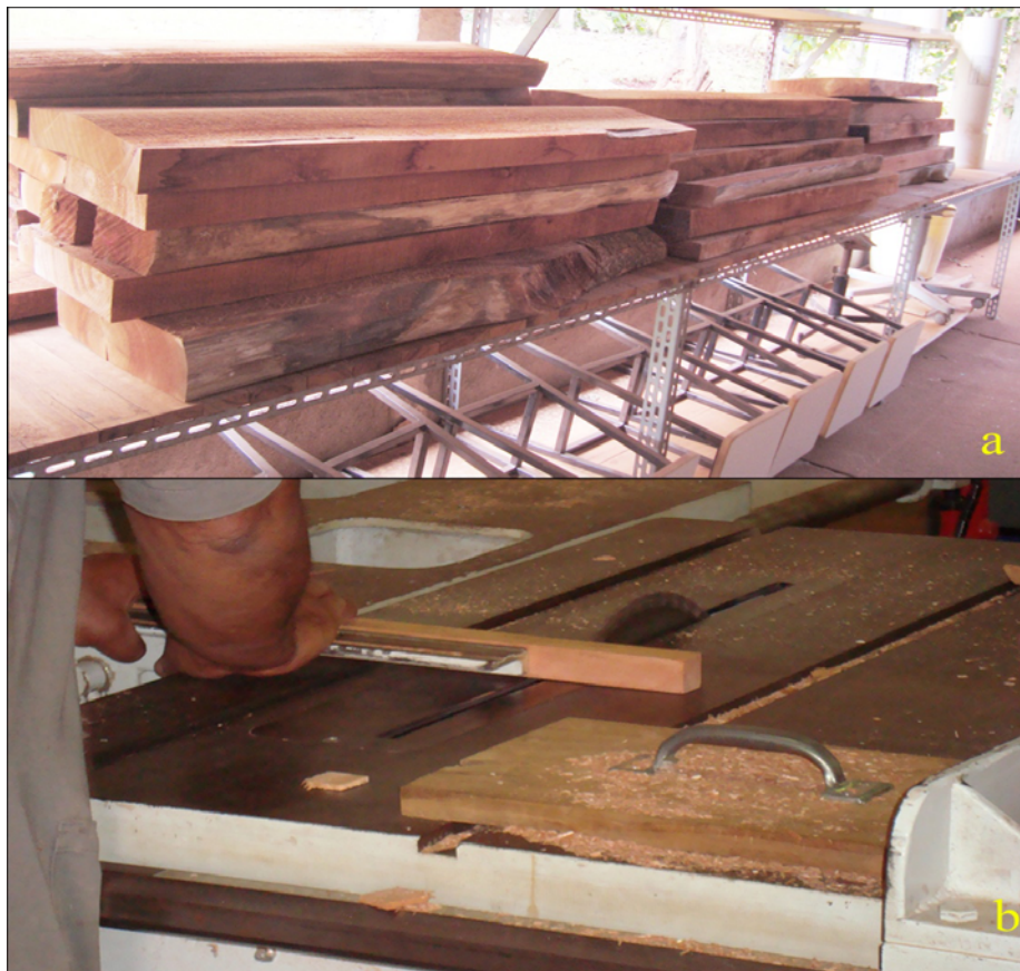
Figura 7 a) Pranchões centrais no Laboratório de Usinagem da Madeira (DCF/UFLA); b) Confeção dos corpos de prova a partir das ripas
