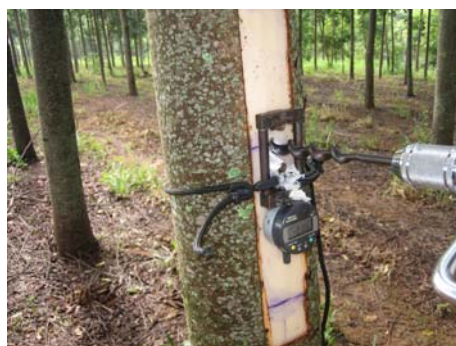
FIGURA 4 Extensômetro para a obtenção das deformações residuais longitudinais (DRL) em Toona ciliata
