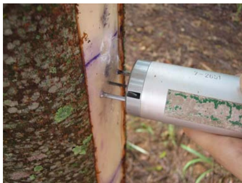
FIGURA 5 Pilodyn utilizado para determinação da densidade, aparelho de avaliação superficial, numa escala de 40mm de profundidade
