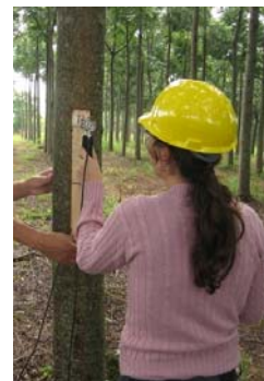
FIGURA 2 e 3 Stress waver timer utilizado para a obtenção da velocidade de propagação das ondas de tensão
