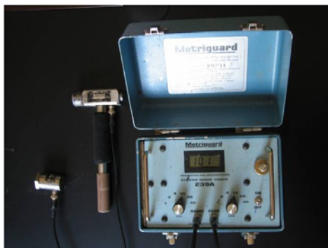
FIGURA 2 e 3 Stress waver timer utilizado para a obtenção da velocidade de propagação das ondas de tensão
