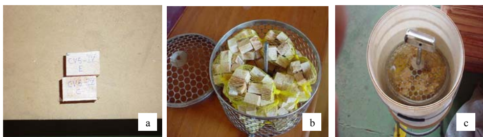
FIGURA 8 – Sequência de imagens ilustrando os procedimentos para completa saturação das amostras de cedro australiano na determinação da retratibilidade da madeira. a – amostras em forma de paralelepípedo; b – recipiente próprio para saturação das amostras e c – amostras submersas em água.
