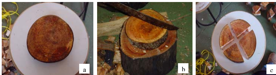
FIGURA 4 – Sequência de imagens mostrando a obtenção das cunhas, sendo: a – disco; b – disco sendo seccionado e c – cunhas.
