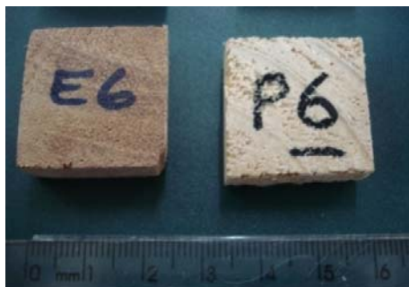
FIGURA 11 Corpos-de-prova de referência, embaúba e pinus.
