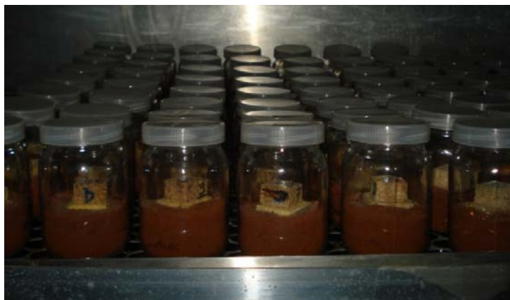
FIGURA 9 Amostras na câmara climática.
