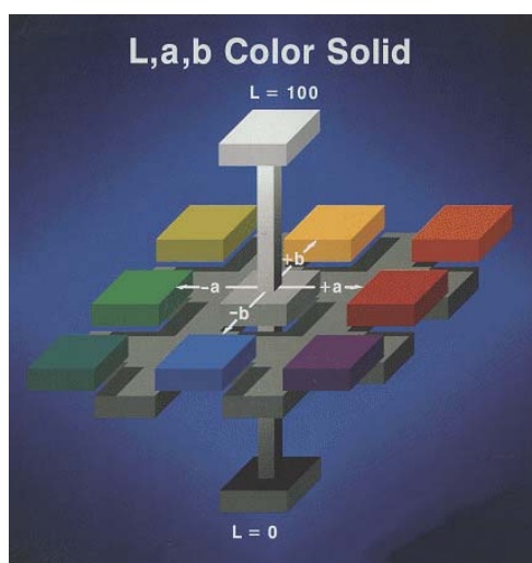
FIGURA 5 Espaço colorimétrico CIELAB. Fonte: González & Macedo (2003).
