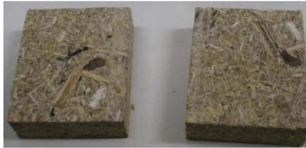
FIGURA 20 Corpo de prova do tratamento C1 cisalhado exatamente na linha de cola após ensaio.
