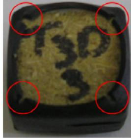
FIGURA 8 Corpo de prova encapado com destaque para as fissuras na borracha.
