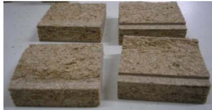
FIGURA 21 Corpos de prova dos tratamentos C2 e C3 com falhas no substrato após ensaio.
