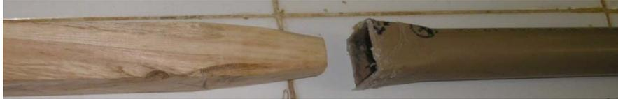
FIGURA 9 Molde de madeira e tubo de PVC adaptado para encaixe dos corpos de prova retangulares.
