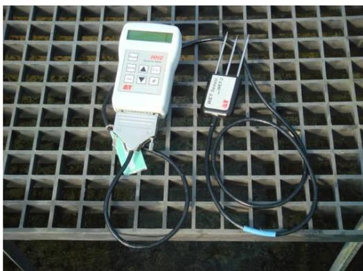
Figura 4A – Aparelho de medição de umidade do substrato
