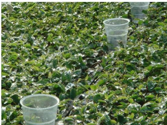
Figura 3A – Coletores com diâmetro de 8,5cm de abertura, para medição do volume de irrigação.
