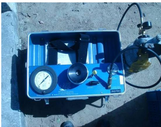
Figura 5A – Câmara de medição de potencial hídrico
