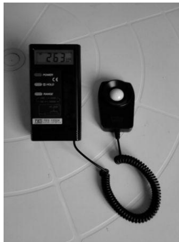
Figura 8. Luxímetro digital portátil utilizado na coleta de dados.
