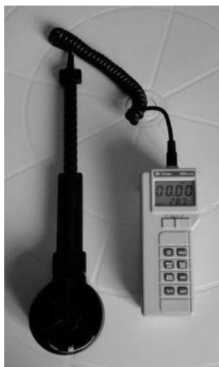
Figura 7. Anemômetro digital utilizado na coleta de dados.
