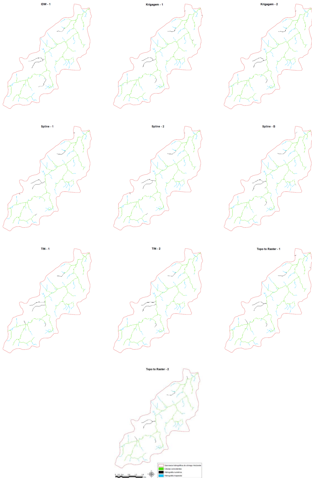
Figura 34 – Coincidência (verde) entre a hidrografia mapeada (azul) e a hidrografia numérica (preto) dos MDEHC gerados (IBGE) com a técnica de Stream Burning .
