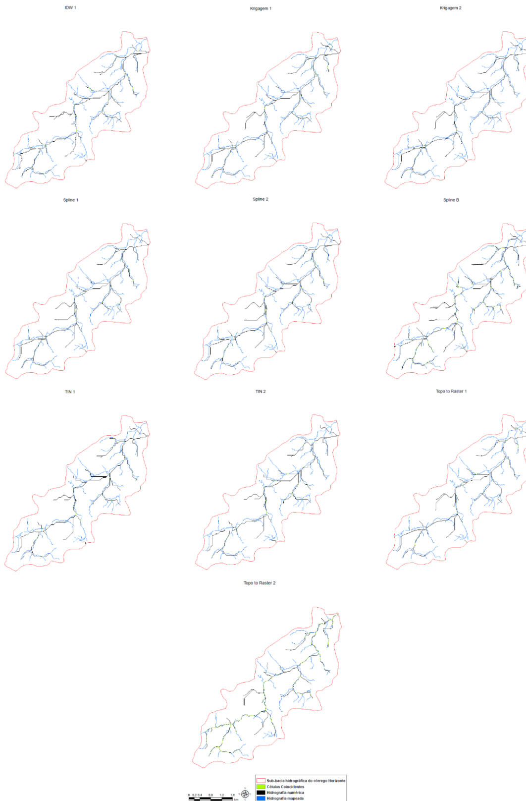
Figura 36 – Coincidência (verde) da hidrografia mapeada (azul) com a hidrografia numérica (preto) dos MDE gerados (SRTM) sem a aplicação da técnica de Stream Burning .
