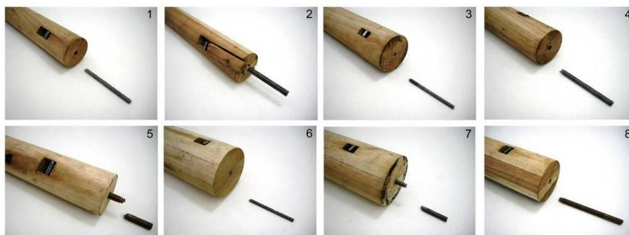
1) barra rosqueada (próximo da porca de fixação); 2) peça de madeira (cisalhamento paralelo às fibras); 3) barra rosqueada (próximo da porca de fixação); 4) barra rosqueada (próximo da porca de fixação); 5) barra rosqueada (distante da porca de fixação); 6) barra rosqueada (próximo da porca de fixação); 7) barra rosqueada (distante da porca de fixação); 8) barra rosqueada (próximo da porca de fixação).
