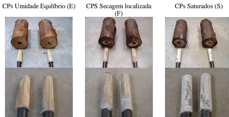
Figura 46 ó Padrões de ruptura da ligação adesiva.
