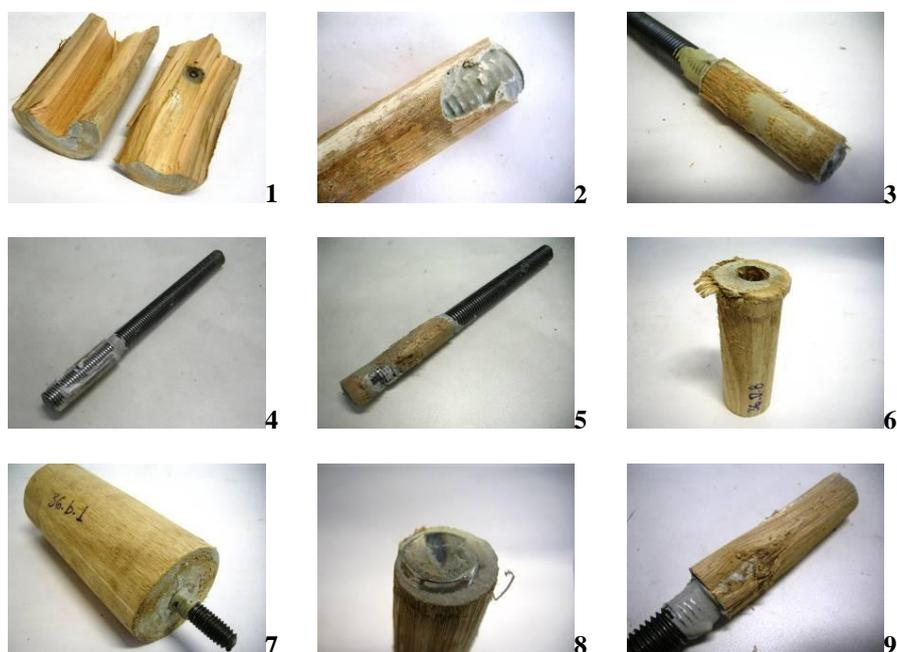
1) cisalhamento paralelo às fibras; 2) falha de adesão (pontual) à madeira; 3) falha de adesão (extensa) à madeira; 4) falha de adesão (extensa) à barra de aço; 5) falha de adesão (ponto) à barra de aço; 6) ocorrência de compressão paralela às fibras, anterior ao cisalhamento; 7) ruptura da barra de aço; 8) seção transversal resistente assimétrica; 9) falha de adesão devido à ocorrência de nós.
