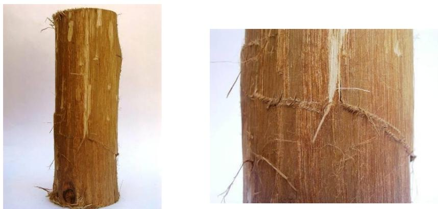
Figura 16 ó Corpo-de-prova submetido a ensaio; detalhe do padrão de ruptura.
