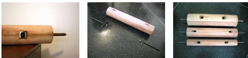
Figura 25 ó Corpos-de-prova (furos quadrados): madeira laminada colada, barra metálica rosqueada, barra chata metálica, porca.
