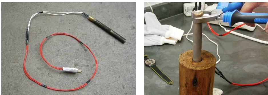
Figura 48 ó Artefato para secagem localizada da madeira: resistência elétrica.
