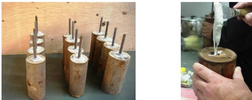
Figura 44 ó Corpos-de-prova e introdução da resina epóxi na peça de madeira perfurada.
