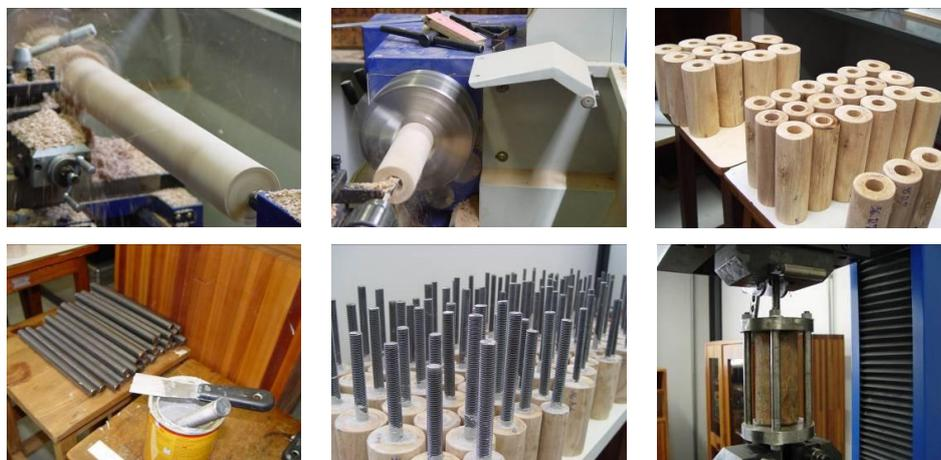
Figura 34 ó Confeção dos corpos-de-prova.
