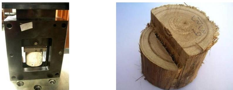
Figura 18 ó Padrão de ruptura dos CPs em ensaio de cisalhamento paralelo às fibras.
