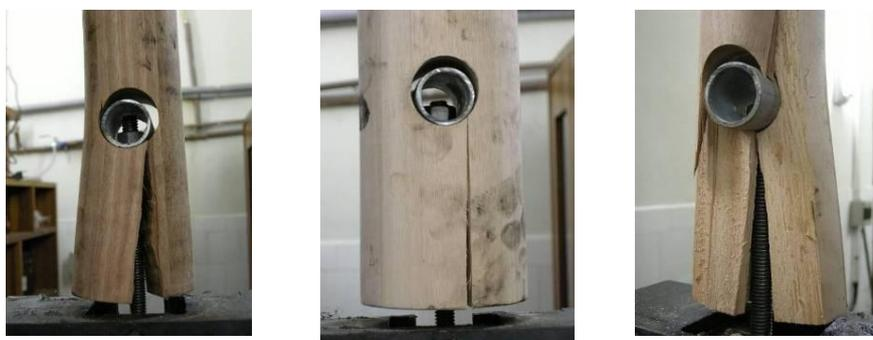
Figura 24 ó Ruptura por fendilhamento.
