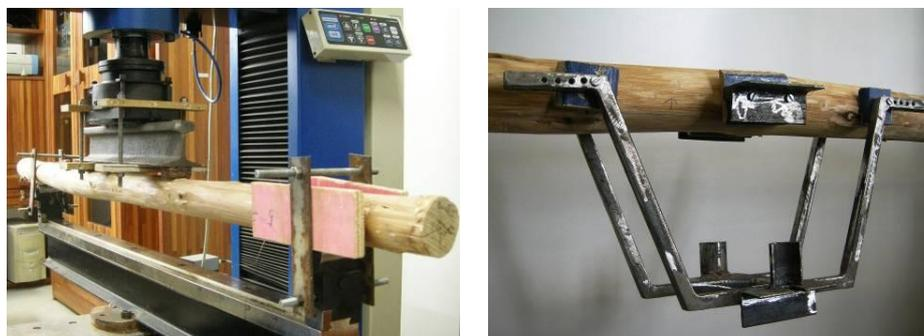
Figura 12 ó Ensaio de flexão estática e mecanismo de suporte dos transdutores, fixados em ambas as faces dos corpos-de-prova.
