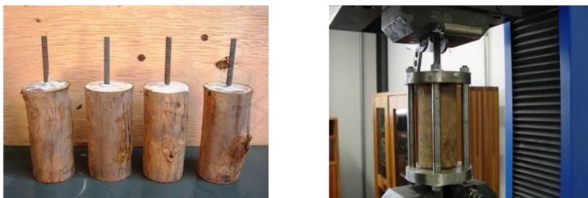
Figura 43 ó Corpos-de-prova e ensaio típico de resistência ao arrancamento.
