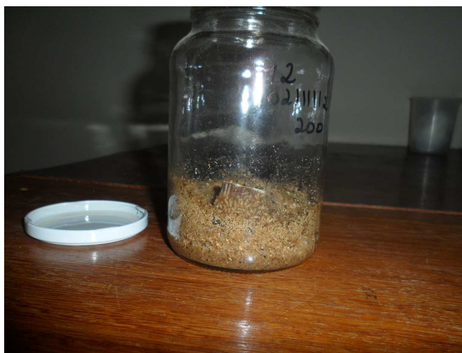
Figura 7. Ensaio com térmitas xilófagos.
