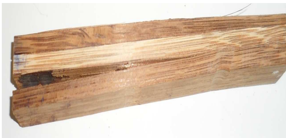
Figura 19. Rompimento parcial do corpo de prova na linha de cola.
