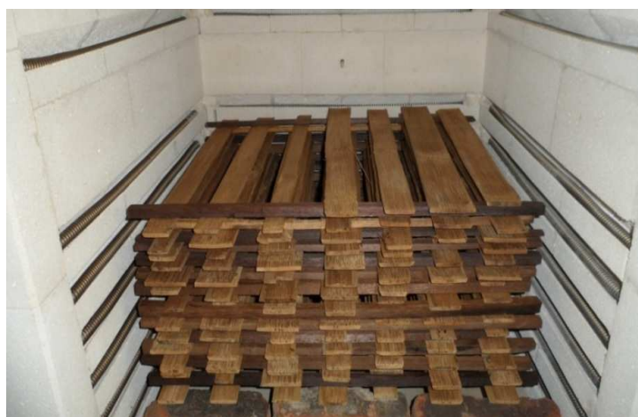
Figura 5. Taliscas de bambu no interior da mufla após o tratamento térmico.
