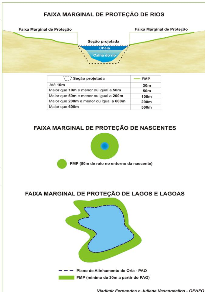
A FMP é calculada a partir do limite de uma seção\* projetada que tem como função escoar, de forma ideal as águas.
