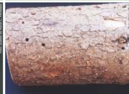
Orifícios de emergência
