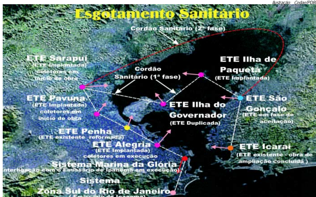
Redes coletoras e estações de tratamento de esgotos formam um cinturão de saneamento ao redor da Baía de Guanabara
