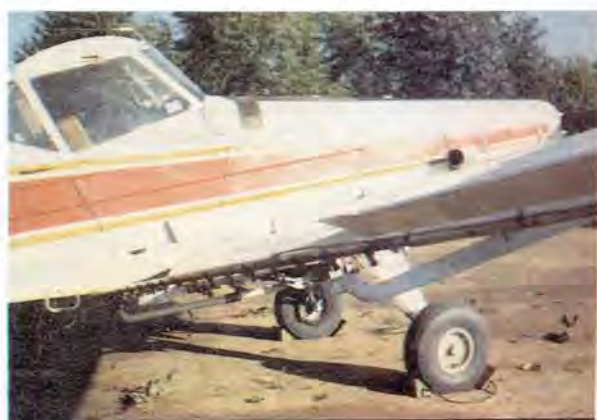
FIGURA 49 - Aeronave agrícola Ipanema 201 - A, equipada com barra, utilizada na aplicação aérea de Bacillus thuringiensis (Berliner).
