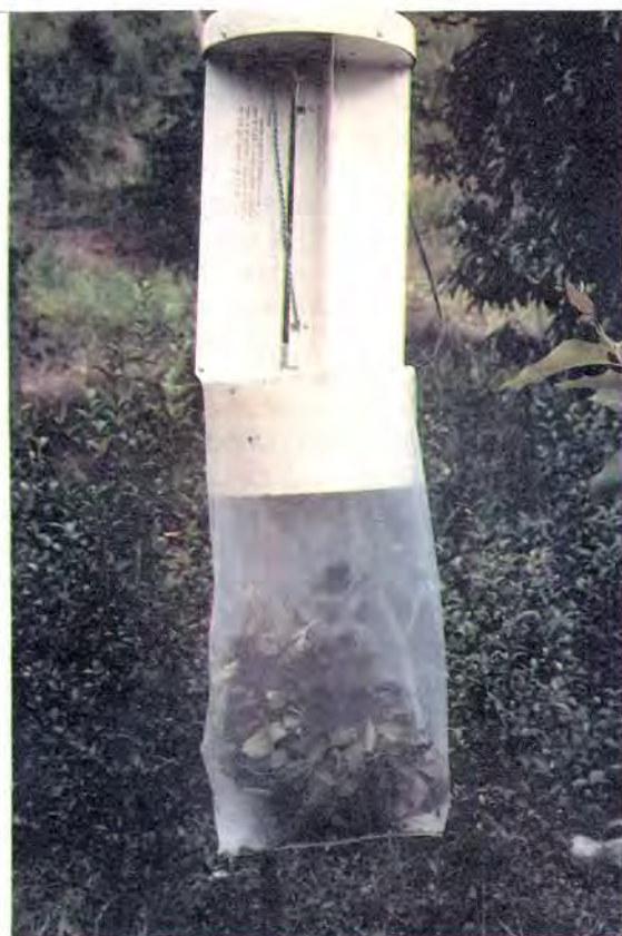
FIGURA 50 -Armadilha luminosa (INTRAL), utilizada na coleta de insetos noturnos e disponíveis no mercado para comercialização.
