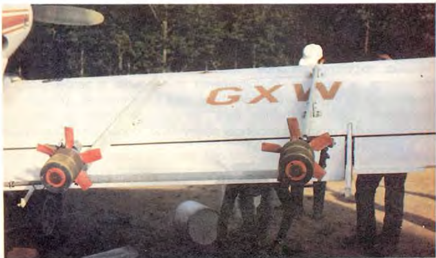
FIGURA 52 - Aeronave agrícola Ipanema 201-A, equipada com bicos de aplicação tipo micron air.
