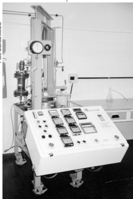
Reator de branqueamento Mark V, da Quantun, no LQCE.
