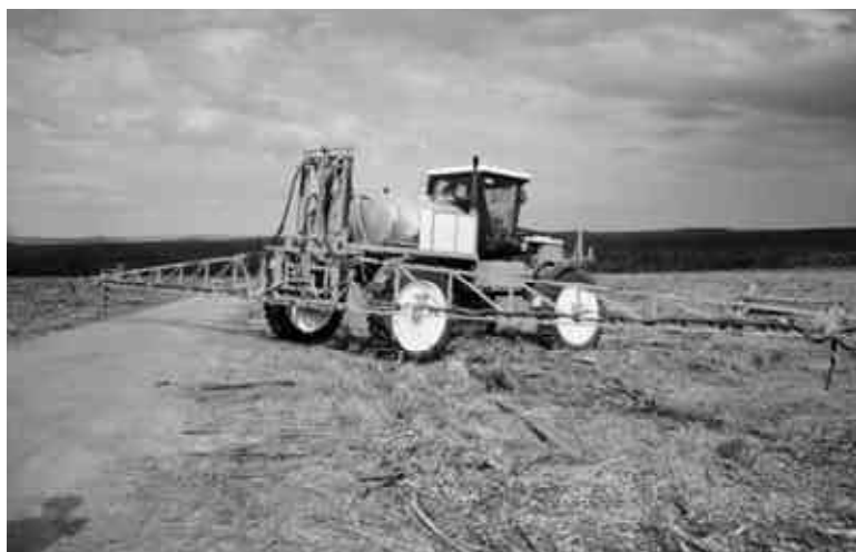
O Regator (equipamento de alto rendimento) pode alcançar até 14 km/h em ambiente florestal, com uma faixa de aplicação entre 18 e 24 metros
